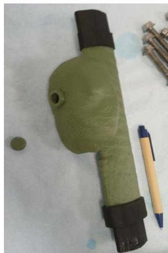
Figure 21 : Fantôme Thorax SPECT/PET – PH-63 – Orion France/Kyoto Kagatu ; avec son insert de rate (34)
