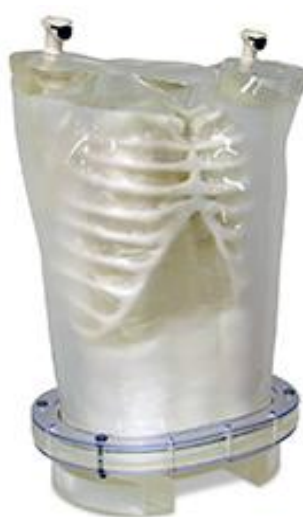
Figure 21 : Fantôme Thorax SPECT/PET – PH-63 – Orion France/Kyoto Kagatu ; avec son insert de rate (34)
