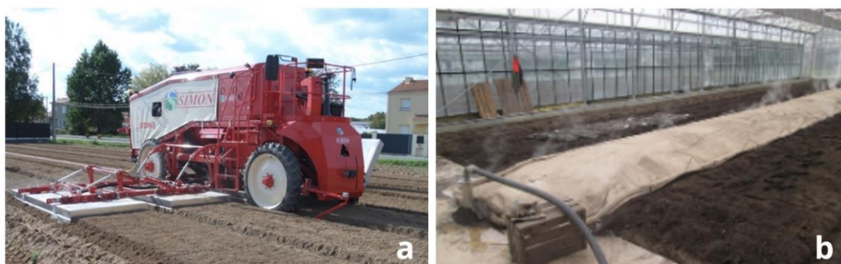
Figure 9. Désinfection vapeur par système de plaque métallique ou de bâche [13], [14]. L'utilisation de plaques métalliques (a) appelées cloches ou coffres permet une désinfection en surface (10 cm maximum) et est la méthode préférée en maraîchage. L'injection de vapeur sous bâche plastique (b) permet une désinfection en profondeur (b) [16]. La désinfection vapeur par système de plaque métalliques qui nécessitait traditionnellement un déplacement régulier est désormais effectuée par un automate.
