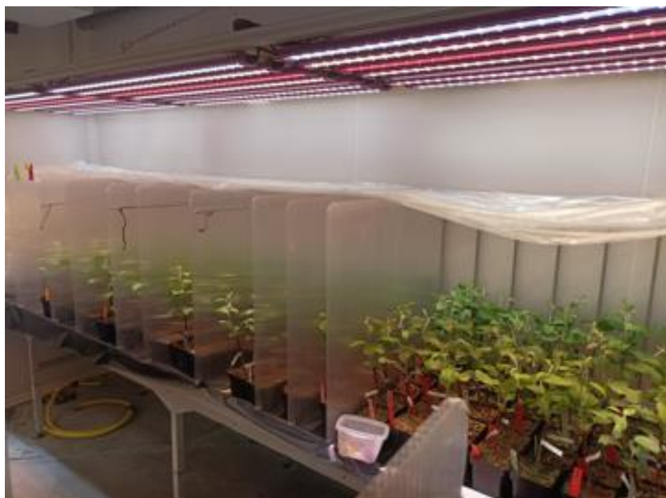
Figure 7 : Dispositif de bâches et de cloisons en salle climatisée pour les tests d'efficacité (Beaucouzé 17/05/23, Pierre Normand)
