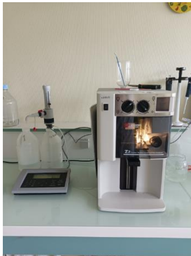
Figure 11 : Compteur de particules (coulter counter) utilisé pour estimer la concentration en spores (Beaucouzé 03/03/23, Pierre Normand)
