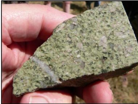
Figure 3 : Rhyolite de Saint-Offrange en coupe. Les feldspaths sont blancs, les quartzes apparaissent en gris clair. (Photo de F. Redois) (LEBLANC T., p.6)
