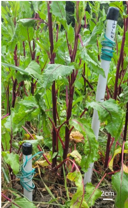
Figure 2 – Photo prise sur la station Brain le 11/05/25 de deux sonde tensiométrique posé à 60 cm de profondeurs (à gauche) et 30 cm de profondeur (à droite)
