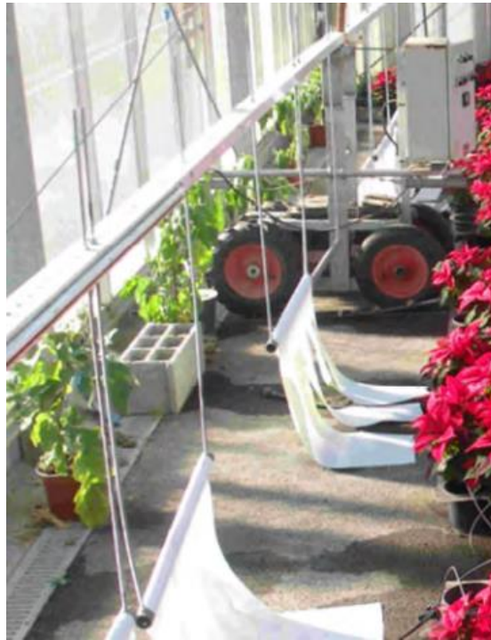
Figure 6 : Chariot d'irrigation adapté pour réaliser le processus de thigmomorphogénèse (AREXHOR, 2012)
