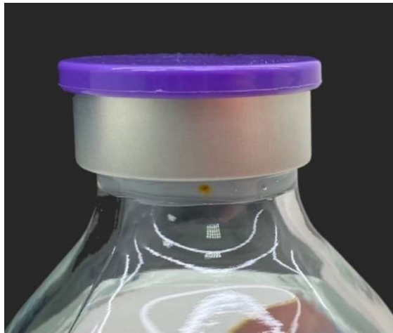
Figure 11 : Exemple de défaut bouchon taché
