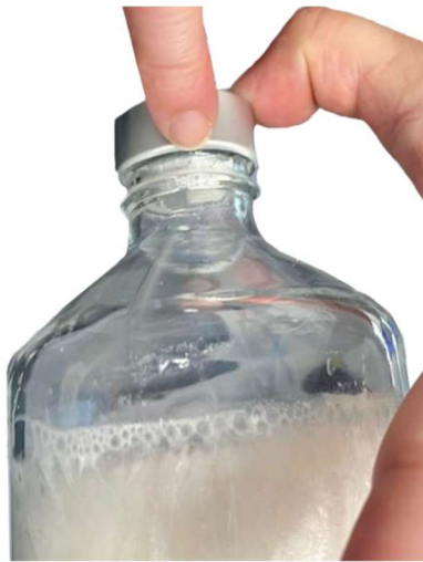
Figure 18 : Présence de lyophilisat au niveau du bouchon
