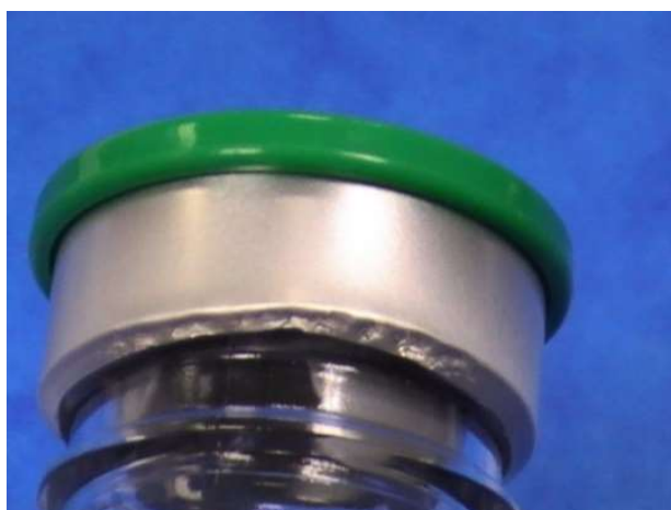
Figure 15 : Défaut mineur au niveau du sertissage "jupe frisée"
