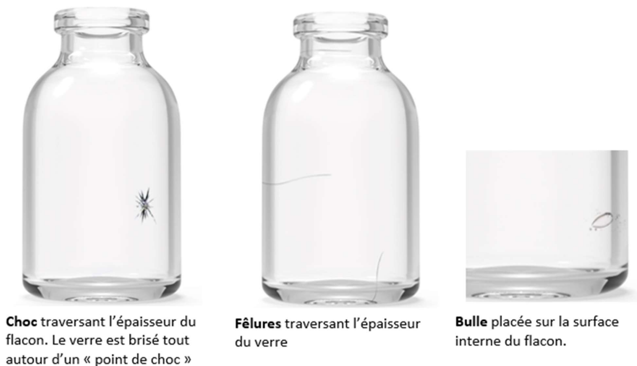
Figure 10 : Exemples de défauts "verre" critiques
