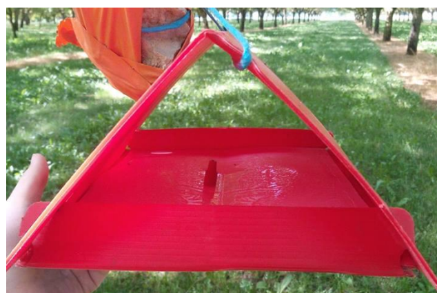
Figure 5. Piège delta rouge contenant une plaque engluée et une capsule de phéromone. Photographie personnelle.
