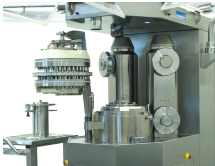
Figure 12. Presse à comprimer avec tourelle interchangeable.
