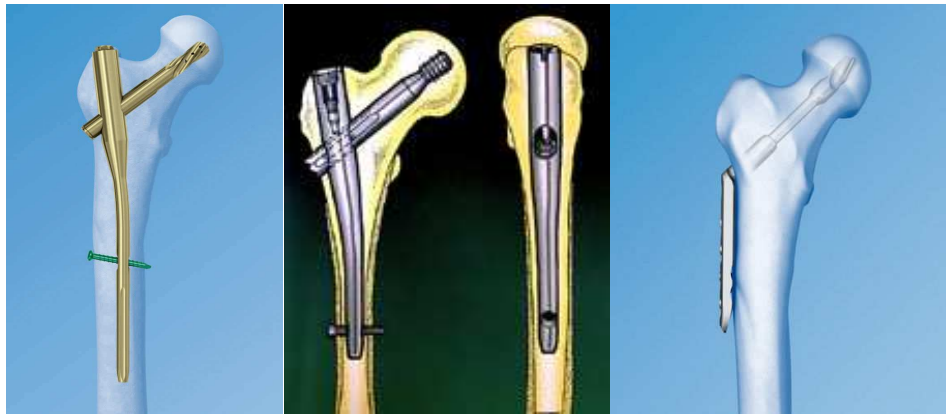
11-Types d'ostéosynthèse utilisés : PFNA®, Clou Gamma®, DHS®
