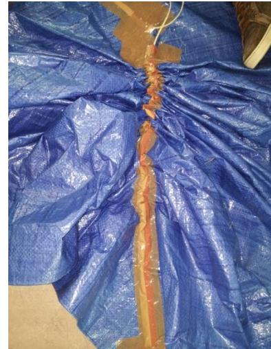
Finalement après un essai avec un câble plus résistant et de la gaine sur les quatre diagonales, un nouveau problème survient c'est que cet ensemble de scotch qui forment la gaine devient trop difficile à plier une fois qui s'accumule au niveau de la boîte. Cette solution ne fonctionne donc pas. Un nouvel essai est tenté en supprimant certaines parties de la gaines pour ne plus en laisser que 10 centimètres tous les 30 centimètres. Cela ne fonctionne pas bien non plus.
