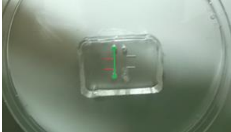
Figure IV-1 : Photographie d'une puce microfluidique posée dans une boîte de pétri.
