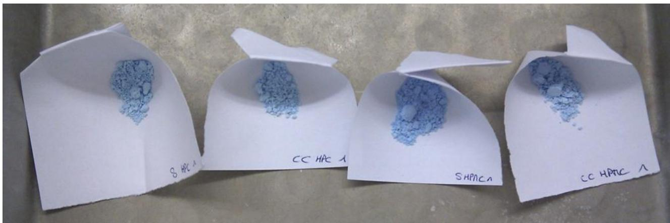
Figure 30 : De gauche à droite, atomisats composés de : Particules nues à base d'HPC ; Particules recouvertes à base d'HPC ; Particules nues à base d'HPMC ; Particules recouvertes à base d'HPMC
