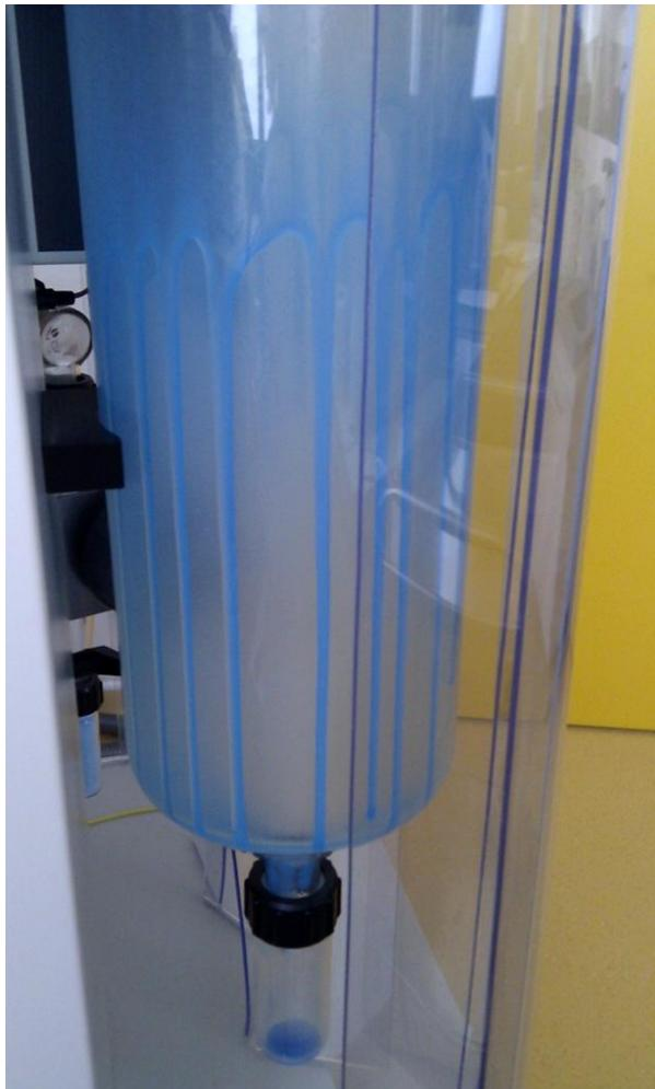
Pour la formule d'HPMC/alginate PG/PA-HP55S® (formule 1), la température d'entrée dans la chambre de séchage a dû être augmentée à 150°C et les débits d'alimentation diminués, compte tenu de l'apparition d'un dépôt liquide sur les parois de la chambre de séchage (Figure 29).
