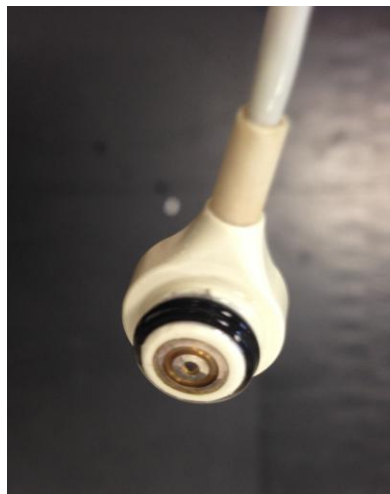
Figure 8 : Exemple d'une électrode avec bague de fixation
