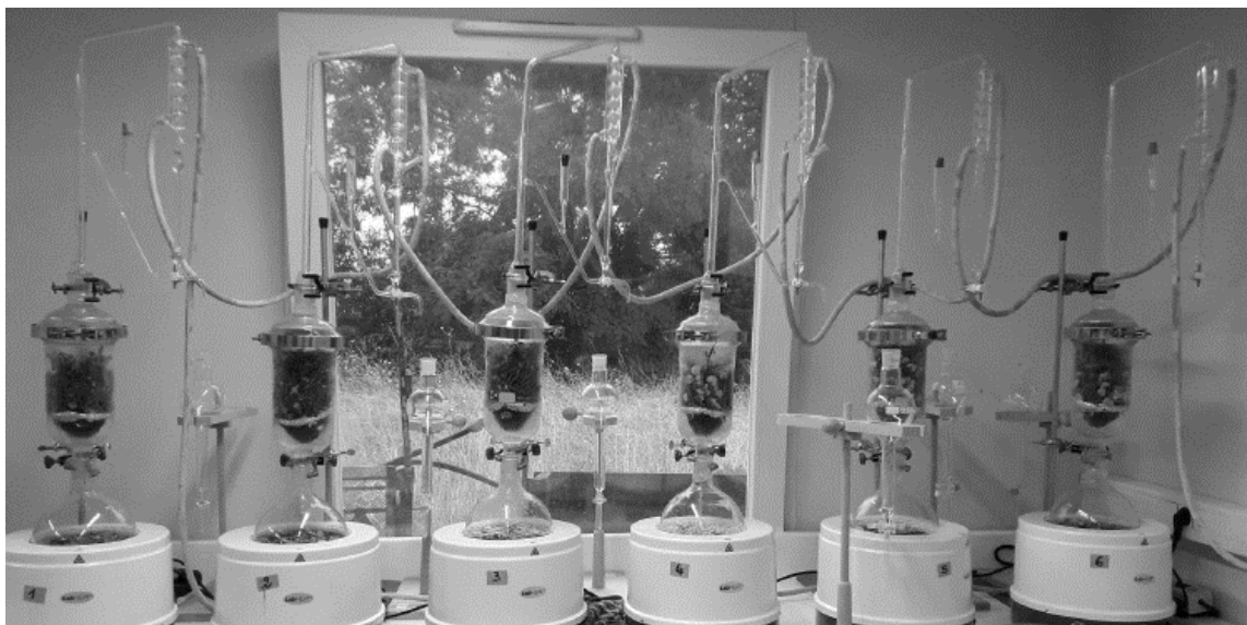
Figure 8. Montage d'une série complète de 6 distillations. Les menthes étaient soumises au passage de la vapeur d'eau pendant deux heures. (Photo Marie Fourage – Projet Carosel).
