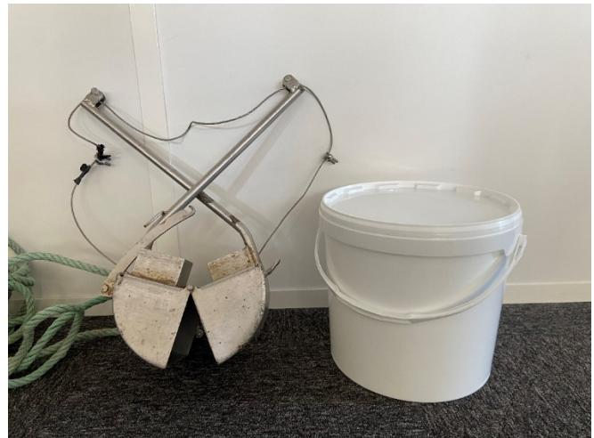
Figure 1 : photo du matériel de prélèvements pour le protocole HP14. À gauche une Benne Van-Veen et à droite un seau en plastique de 15 L.
