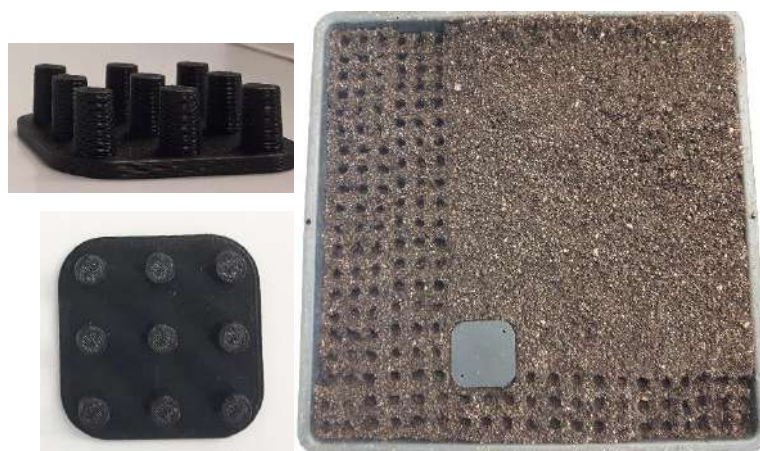
Figure 16 : Echantillon de l'empreinte de la Figure 15. A gauche, des photos du prototype de 9 trous ; à droite, un aperçu du résultat obtenu sur les terrines de terreau.
