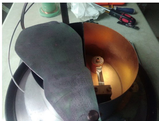
Figure 16: (gauche) Creuset n°1 contenant le chrome en poudre. (centre) Creuset n°2 contenant 6 cm de fil d'or. (droite) Schéma d'une électrode
