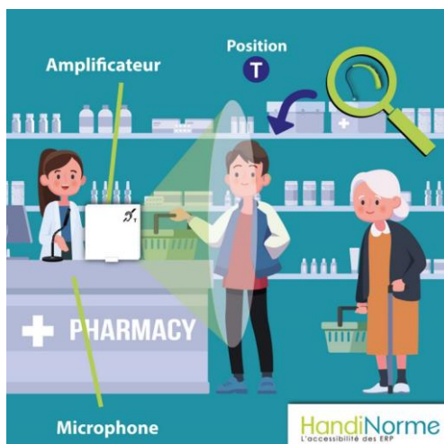
Figure 38: Schéma représentant l'installation d'un kit amplificateur de boucle (48)
