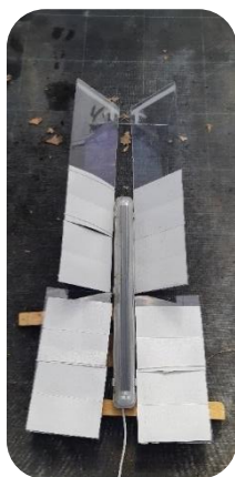
Figure 22 : piège de type « plat » et type « V » associé au tube néon UV-A (Crédits photos : Amélie Baillou, Arexhor PL, 18/05/2020).
