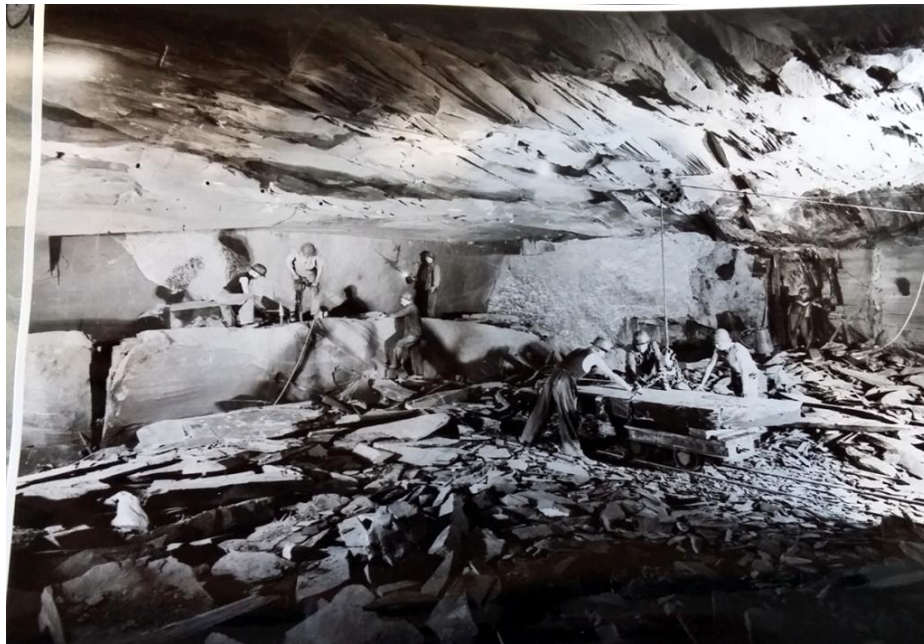
Figure 3 : Ardoisières d'Angers-Trélazé – Débitage d'un bloc de schiste dans une chambre d'exploitation, non daté (ADML, 15 J 606)
