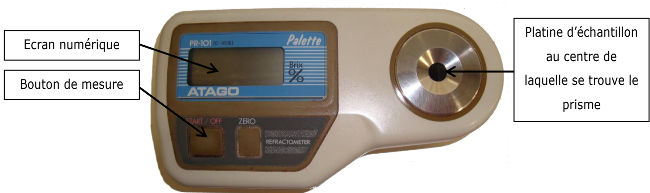
Figure 8 : Photographie d'un réfractomètre numérique mesurant le taux de sucre du jus
