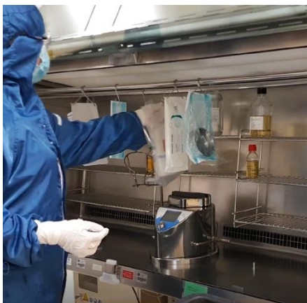
Figure 35. Photo du technicien effectuant le chargement de l'isolateur.
