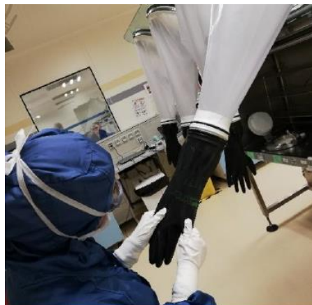
Figure 34. Photo du technicien effectuant le contrôle d'intégrité du gant de l'isolateur.
