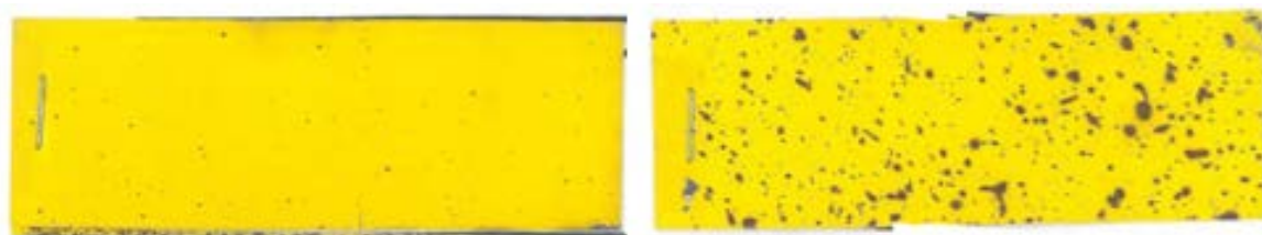
Figure 31 : Papiers hydrosensibles du pulvérisateur équipé de buses ATR à gauche et de buses TVI en haut de la rampe à droite.
