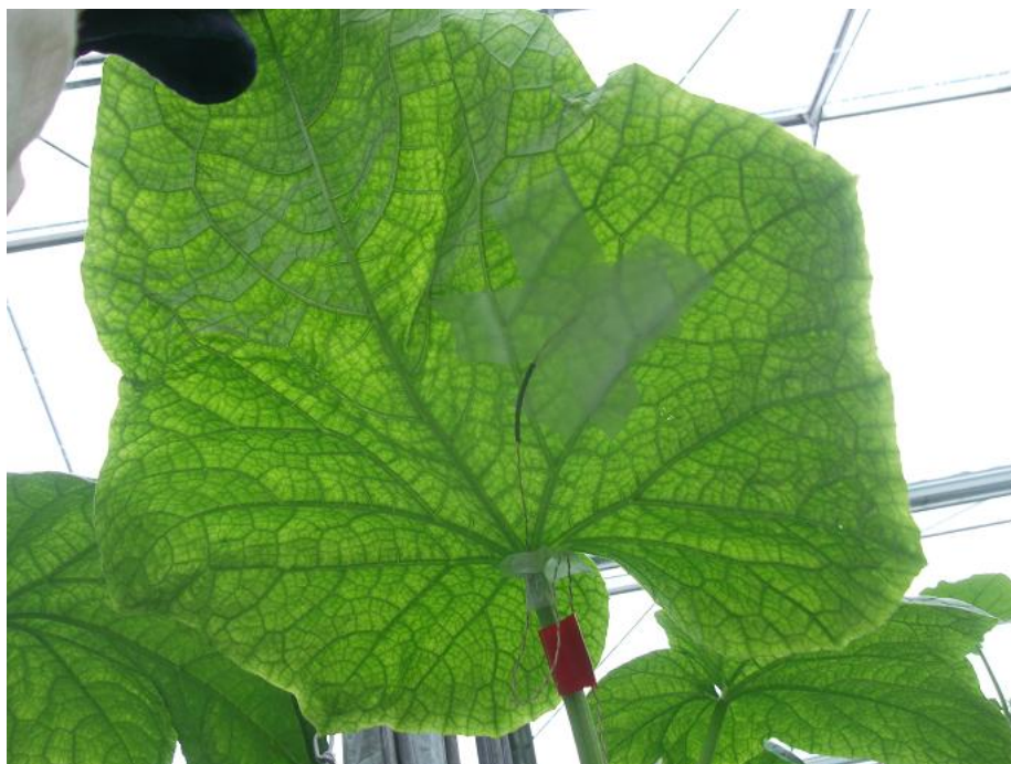
Figure 11 Photographie d'une feuille de concombre sur laquelle un thermocouple est fixé par du ruban adhésif (SCEA Cheminant)
