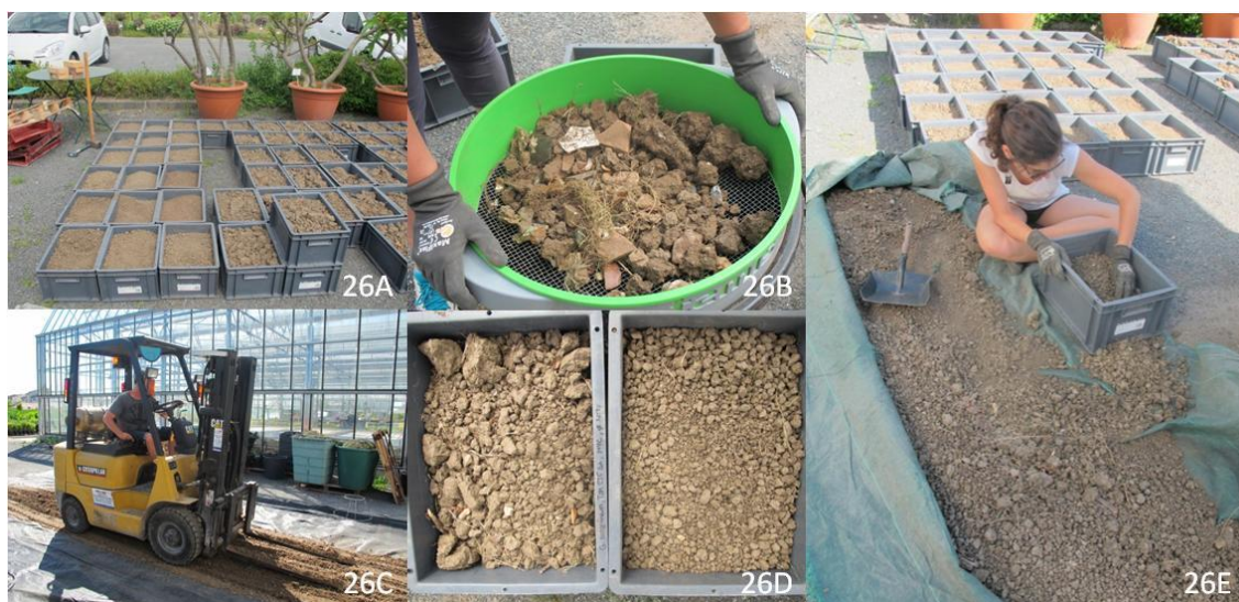
Figure n°26 : Photographies du séchage du sol (26A), du tamisage du sol (26B), de l'écrasement des mottes (26C) et du tri des mottes (26D et 26E) (Sourzat, 2016, ASTREDHOR Sud-Ouest)
