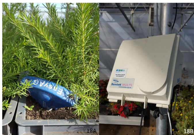
Figure n°18 : Photographies des Sondes EasyAG® 50 (18A) et du boîtier Sentek MULTI® (18B) pour l'arrosage (Sourzat, 2016, ASTREDHOR Sud-Ouest)
